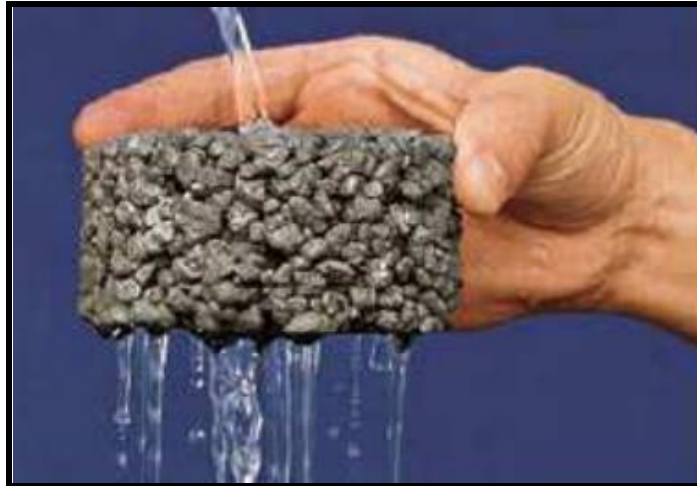
Figura 12 - Dispositivo de controle de escoamento – Pavimento Poroso
